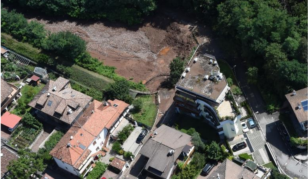
Abbildung 12: Das Speicherbecken, welches Steinmannwald schützt, hielt das Material effektiv zurück
